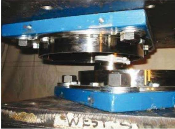
Gli isolatori a scorrimento a superficie curva usano la forza di gravità come forza di ricentraggio; il principio di funzionamento è quello del pendolo. La dissipazione di energia è fornita dall'attrito della superficie di scorrimento principale. I parametri del legame costitutivo bilineare dipendono dal raggio di curvatura e dal coefficiente di attrito.
